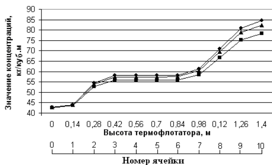
Рис. 20. Влияние температуры флотации T_f на изменение концентраций. Линиями указаны: ■ — T_f = 65^\circ\text{C} , ▲ — T_f = 80^\circ\text{C} , ◆ — T_f = 95^\circ\text{C}
